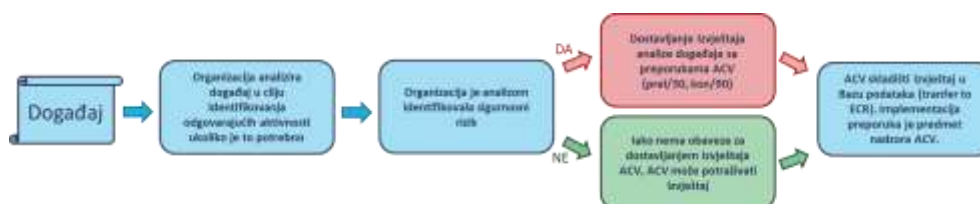
Slika 2 – Grafički prikaz procesa analize događaja unutar organizacije i dalja komunikacija sa ACV
